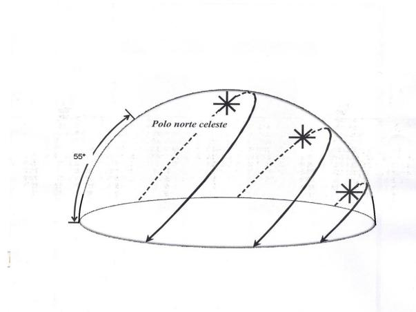
Figura 1.16: Trayectorias de las estrellas como las ve un observador en la ciudad de Moscú a  $55^\circ$  de latitud Norte. Para un observador en esta *latitud* las trayectorias son muy inclinadas respecto del *plano horizontal* del observador.
