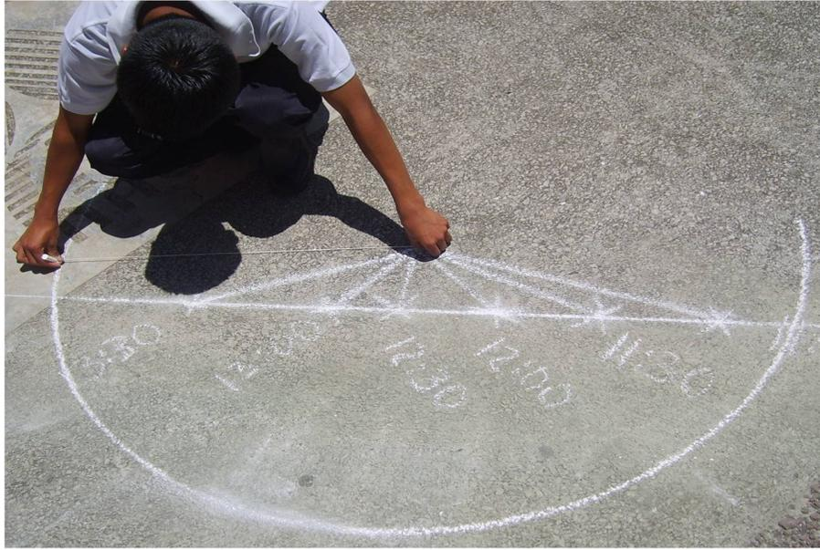
Figura 1.8: En esta imagen se está trazando un segmento de arco con una cuerda que está en el punto sobre el que se colocó el mástil, se ve el trazo de una línea sobre las cruces (que denotan los extremos de las sombras). Esta línea está orientada de Este a Oeste. La longitud de la cuerda se elige de tal manera que el arco cruce en dos puntos a la línea Este-Oeste. La línea que va de la mitad entre dichos puntos de cruce y la base del mástil está alineada en dirección Norte-Sur.
